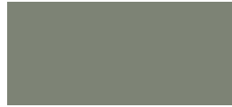
PATINA GREEN LOW GLOSS: SR: 0.38 E: 0.87 SRI: 41 STD. GLOSS: SR: 0.46 E: 0.85 SRI: 51
